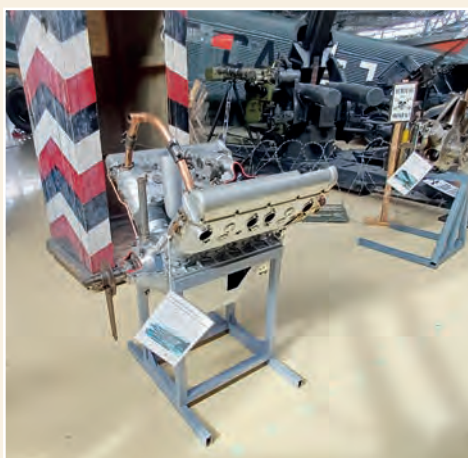
Sjølvsagt var det og eit eksemplar av den mest kjente flymotoren av dei alle. Rolls-Royce Merlin V12, brukt blant anna i Spitfire og Lancaster 4-motors bombefly.
