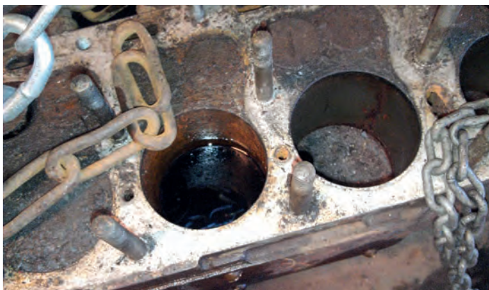
Før boring såg ikkje alle sylindrane like bra ut.
