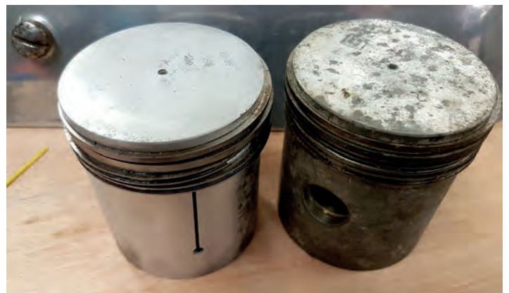
Vasspolert stempel til venstre ser nytt ut, men det er superviktig å sjekke for gløymde glaskuler.
